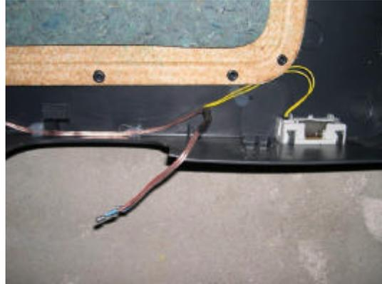
Zum Schluß wird mittels zweier Stromdiebe die Leitung an der gewählten Innenraumleuchte angeklemt.
