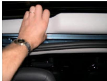
Anschließend werden die beiden Seitenteile (links und rechts der Heckscheibe) **im Mittelabschnitt** fest, aber vorsichtig zur Mitte der Heckscheibe hin abgezogen. **Keinesfalls diese Teile in Richtung Laderaumboden ziehen**; die Klipse sind seitlich in Langlöchern eingesteckt !
