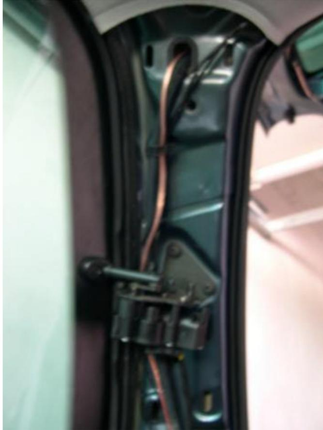
durch die erwähnte Gummitülle in die Heckklappe und dort entlang der vorhandenen Leitungen zur unteren Klappenkante. Dort endet es in 2 Stoßverbindern.
