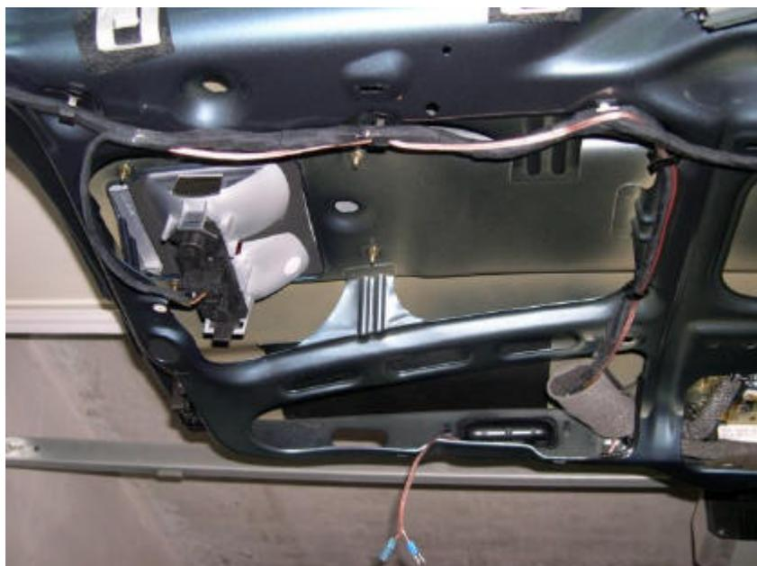
Die restliche Verkabelung findet in der Verkleidung statt. Hier zweigen an geeigneter Stelle die konfektionierten VW-Kabel mit Stecker von einer fest verlegten Leitung ab, die ihren Anfang auch in 2 Stoßverbindern – den Gegenstücken zu denen in der Heckklappe – nimmt. Diese fest verlegte Leitung wird z.B. mittels einiger Heißkleber-Punkte in der Verkleidung fixiert.
