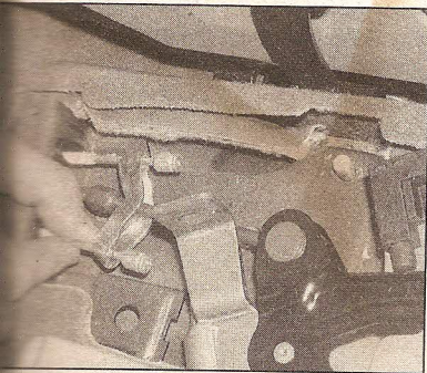
16.4 Désaccouplement d'un câble de frein à main sur le palonnier
