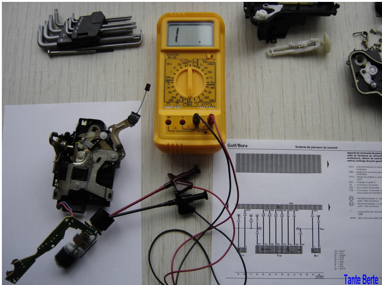
Figure 9 – la vérification de chaque switch à l'aide d'un multi testeur.
